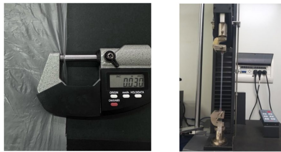
a) The thickness test of PE film b) The tensile test of PE film
