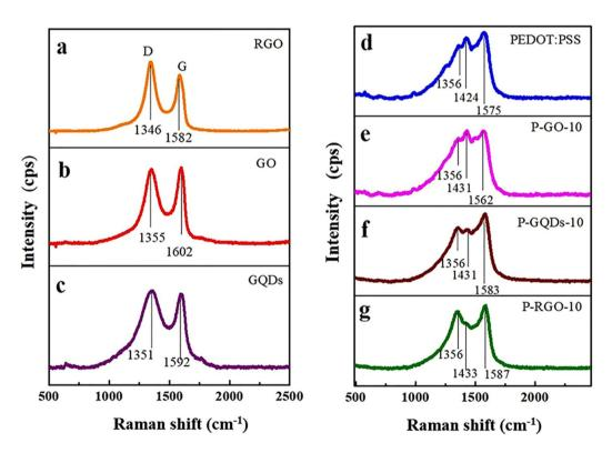
**Figure 4.** Raman spectra of (**a**) RGO, (**b**) GO, (**c**) GQDs, (**d**) PEDOT:PSS, (**e**) P-GO-10, (**f**) P-GQDs-10, and (**g**) P-RGO-10.
