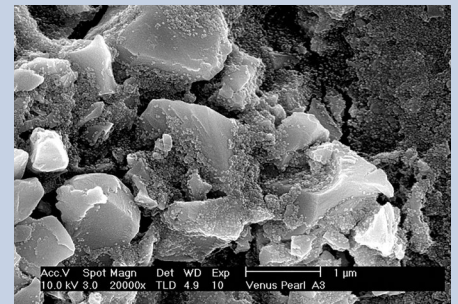
Fig. 2 SEM of irregular filler composite material
